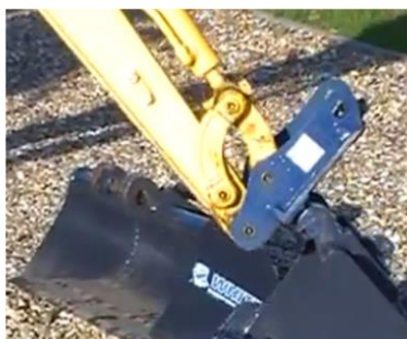
4. Pose du godet au sol
